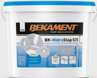
**Primjena:** Dvokomponentni, hidroizolacijski, fleksibilni polimer cementni premaz za okomitu i vodoravnu zaštitu površina od vlage. Koristi se za hidroizolaciju potencijalno vlažnih prostorija: kuhinja, kupaonica, tuš kabina, bazena, podrumskih površina, terasa, itd. Namijenjen za vanjsku i unutarnju upotrebu, za pozitivni i negativni tlak 1,5 bar.
